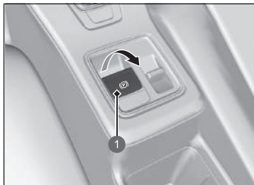
1 Interruttore del freno di stazionamento
