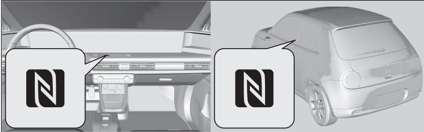
Per le versioni con guida a destra, i contrassegni NFC si trovano sul lato diametralmente opposto a quello delle versioni con guida a sinistra.
