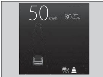
Il veicolo mantiene la velocità impostata senza dover tenere il piede sul pedale del freno o dell'acceleratore.
