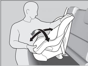
3. Spingere la linguetta verso il basso. Disporre la parte superiore della cintura nella fessura sul lato del seggiolino.
