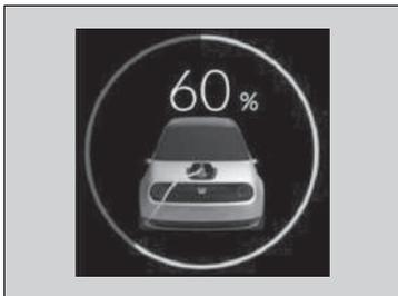
Visualizza lo stato corrente della batteria ad alta tensione.
