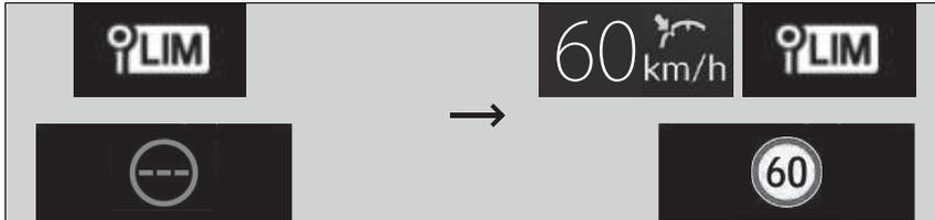
■ **Quando il sistema di riconoscimento della segnaletica stradale non rileva il limite di velocità per un certo periodo di tempo mentre il limitatore di velocità intelligente è attivato**
