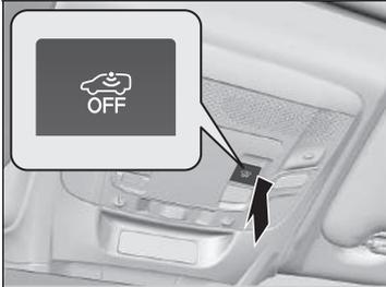
È possibile inserire il sistema antifurto senza attivare i sensori ultrasuoni.
