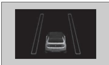
Quando il sistema LKAS viene sospeso, le linee della corsia sul quadro strumenti diventano linee di corsia doppie e il cicalino suona (se attivato).
