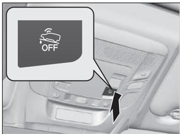
È possibile inserire il sistema antifurto senza attivare il sensore di inclinazione.
