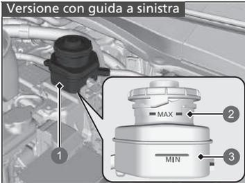
Il livello del fluido deve essere compreso tra le tacche **MIN** e **MAX** poste sul lato del serbatoio di riserva.
