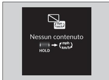
Consente di visualizzare un'altra unità sull'interfaccia informazioni del conducente e di impostare le misurazioni visualizzate per la lettura in km e km/h o e miglia e mph.
