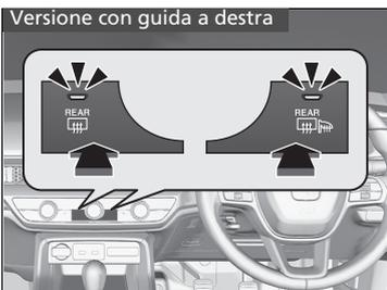
Il lunotto termico e gli specchietti retrovisori riscaldati\* si disattivano automaticamente dopo 10-30 minuti a seconda della temperatura esterna. Tuttavia, se la temperatura esterna è pari o inferiore a 0°C, non si spengono automaticamente.
