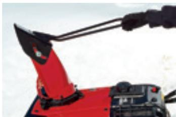
*Camino di espulsione a controllo manuale su modello HS 750 EMA*
