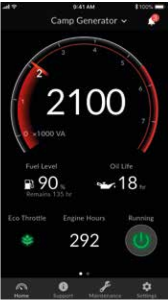
Un'app intelligente dà accesso alle funzionalità del generatore quali l'indicatore del carburante, l'autonomia di lavoro e gli avvisi di manutenzione.
