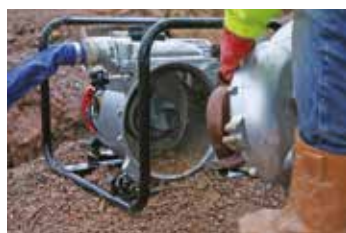
Il coperchio di controllo rimovibile agevola l'ispezione interna.
