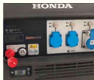
Premere il pulsante per azionare il motore
