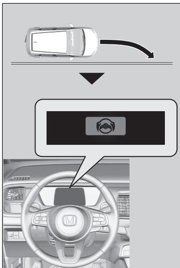
La telecamera anteriore posizionata dietro lo specchio retrovisore monitora le linee di demarcazione corsia di sinistra e destra, bianche o gialle, il bordo esterno del manto stradale (confinante con erba o ghiaia) o i veicoli in arrivo rilevati. Se il veicolo si avvicina alle linee di demarcazione corsia rilevate, al bordo esterno del manto stradale (confinante con erba o ghiaia) o a un veicolo in arrivo dalla corsia opposta senza gli indicatori di direzione azionati, il sistema si attiva.
