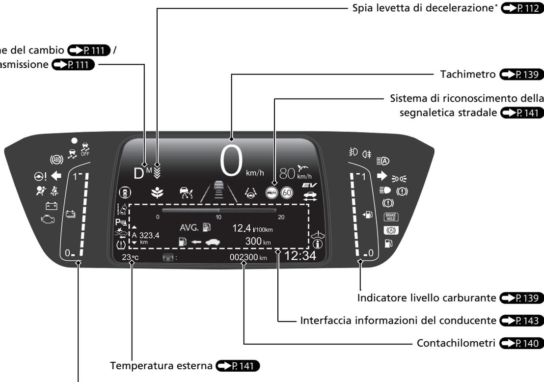
Indicatore livello di carica della batteria ad alta tensione [↔ P.140](#)
