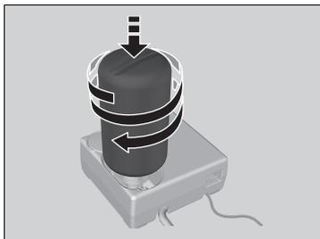
**5.** Avvitare il flacone di sigillante sul compressore aria.
