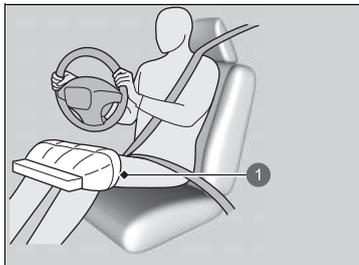
Quando l'airbag anteriore lato conducente si gonfia, si gonfia anche l'airbag per le ginocchia.
