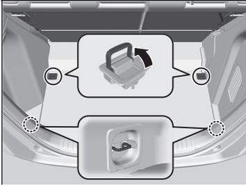
I punti di ancoraggio sul pianale del bagagliaio possono essere utilizzati per installare una rete per il fissaggio degli oggetti.
