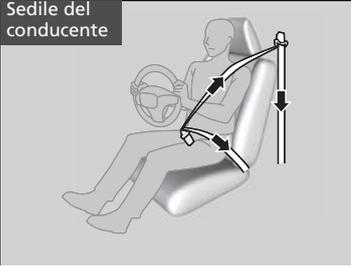
I sedili anteriori e i sedili posteriori esterni sono dotati di pretensionatori automatici delle cinture di sicurezza per aumentare il livello di sicurezza.
