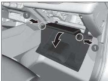
2. Disinserire le due linguette premendo ciascun pannello laterale.
