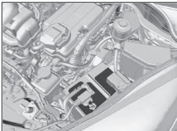
Lo stato della batteria è monitorato da un sensore situato sul terminale negativo della batteria. In caso di problemi con questo sensore, l'interfaccia informazioni del conducente visualizza un messaggio di allerta. In questo caso, far controllare il proprio veicolo presso una concessionaria.
