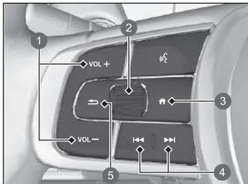
Consentono di agire sul sistema audio durante la guida. Le informazioni vengono visualizzate sull'interfaccia informazioni del conducente.
