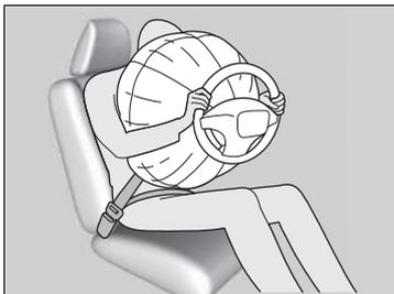
In caso di incidente la cintura di sicurezza trattiene il tronco, mentre l'airbag anteriore fornisce la protezione supplementare per la testa e il torace. Gli airbag anteriori si sgonfiano immediatamente, in modo da non interferire con la visibilità del guidatore e la capacità di sterzare o azionare gli altri comandi.
