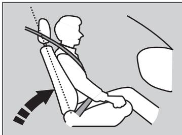
Regolare lo schienale del sedile lato guida in posizione perpendicolare al sedile, assicurandosi che vi sia spazio sufficiente tra il torace e il coperchio dell'airbag al centro del volante.
