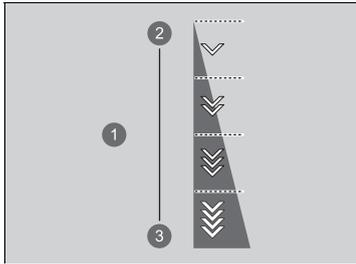
Ciascun azionamento della levetta comporta la modifica di una fase singola della decelerazione.
