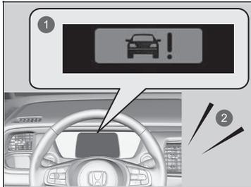
Il sistema genera avvisi acustici e visivi di una possibile collisione e si arresta se la collisione viene evitata.
