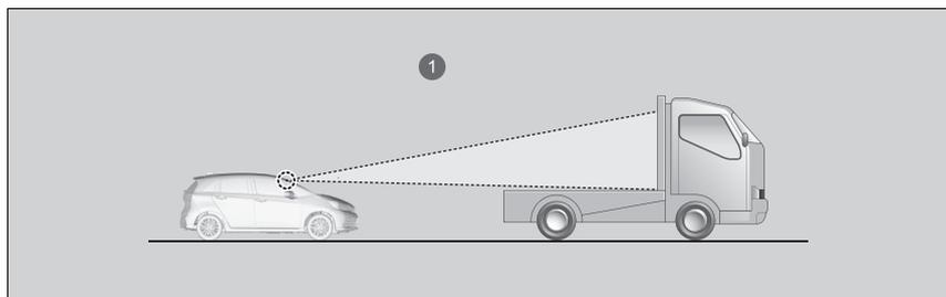
1 La telecamera rileva la parte superiore di un autocarro con pianale vuoto.
