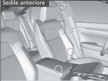
Durante la sostituzione delle cinture di sicurezza, utilizzare i punti di ancoraggio mostrati nelle immagini. Il sedile anteriore è dotato di una cintura di sicurezza a tre punti di ancoraggio.
