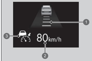
Quando l'ACC con adattamento velocità ad andatura lenta inizia a funzionare, sul quadro strumenti vengono visualizzate l'icona del veicolo, le barre della distanza e la velocità impostata.
