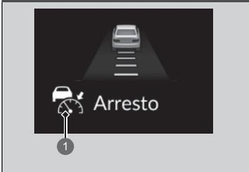
Anche il proprio veicolo si arresta automaticamente. Sul quadro strumenti viene visualizzato il messaggio **Arresto**.
